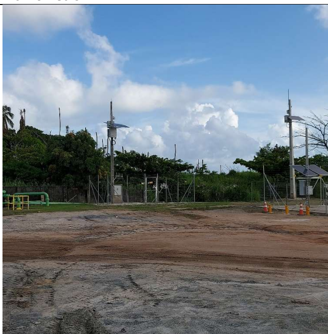
Foto 18 – Instalações de DGPS, tiltímetro e inclinômetro
